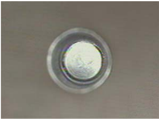
〔図9〕 引っ張りテスト後の溶接部を内部から見た写真
