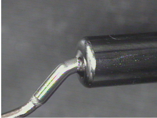
[ 図5 ] SUPER LASERによる溶接サンプルの曲げテスト結果
