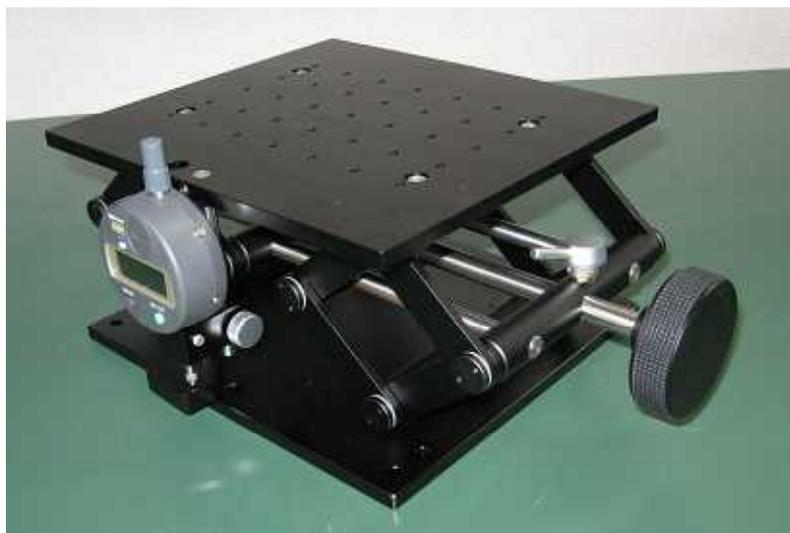
デジタルゲージが付いているので、高さ移動量を管理することが容易になります。デジタルゲージの測定範囲は12.7mmですが、ホルダを移動できるので全範囲での測定が可能です。
