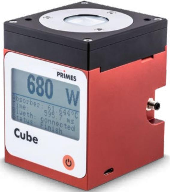
コンパクト設計、外部ディスプレイ、電源ケーブル、冷却水供給用チューブなど一切不要なので、加工レーザシステム内部の非常に狭いスペースで、ハイパワー密度レーザの測定が可能です。一部のハイパワーレーザのアプリケーションでは、パワー密度が高すぎて一般的なパワーメータでは吸収体のコーティングが損傷してしまいますが、Cube Mは、最大パワー2kW、最大パワー密度250kW/cm<sup>2</sup>まで対応しており、ハイパワー密度のレーザパワーモニタリングに最適なパワーメータです。
